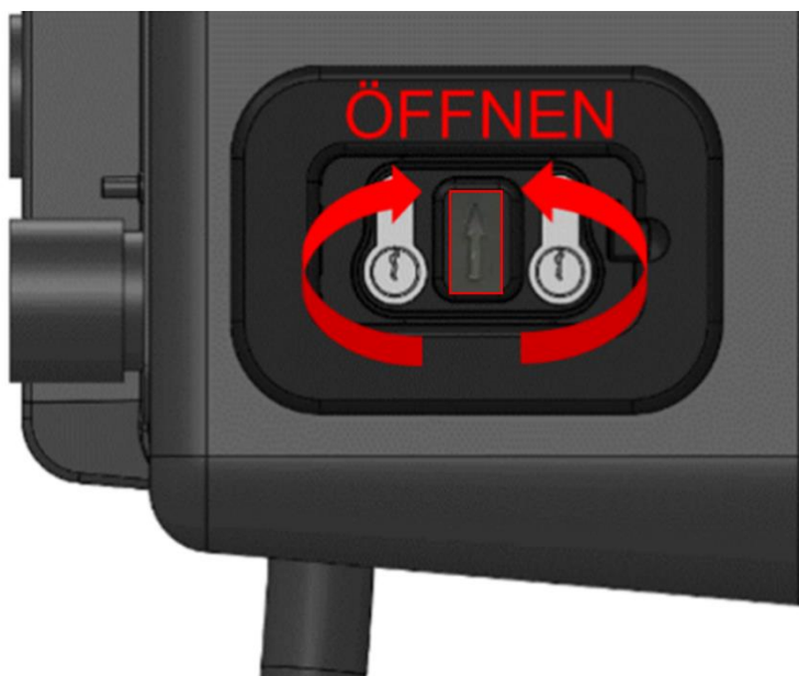
Abbildung 10: Serviceluke für Zugang zum HYC50
