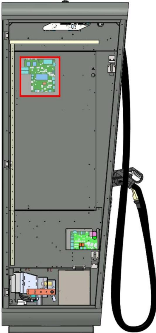
**Abbildung 25:** Position der CTRL\_COM im Hypercharger
