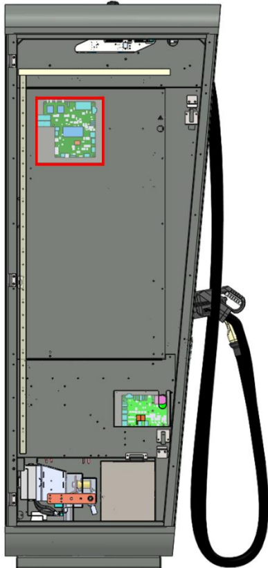
Abbildung 30: Position des CTRL_COM im Hypercharger
