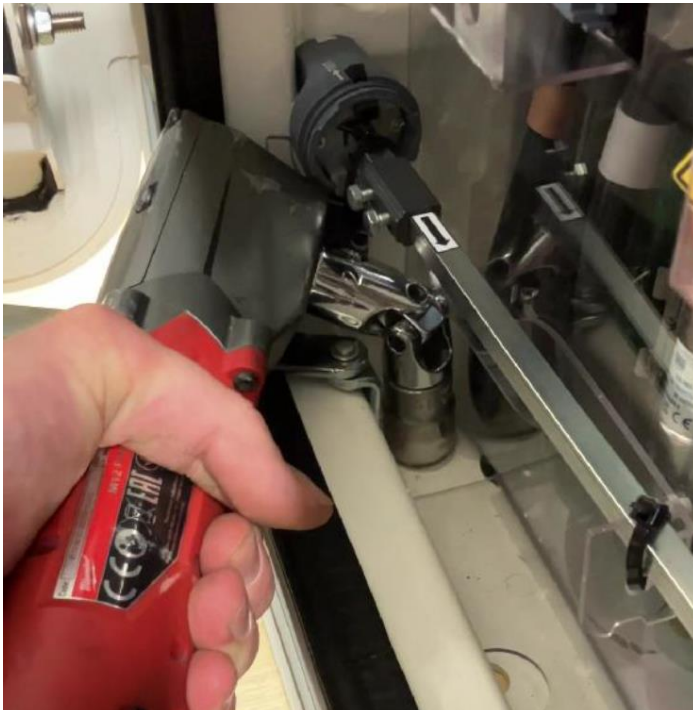
Abbildung 43: Winkeladapter-Einsatz zum Lösen der Palettenschrauben
