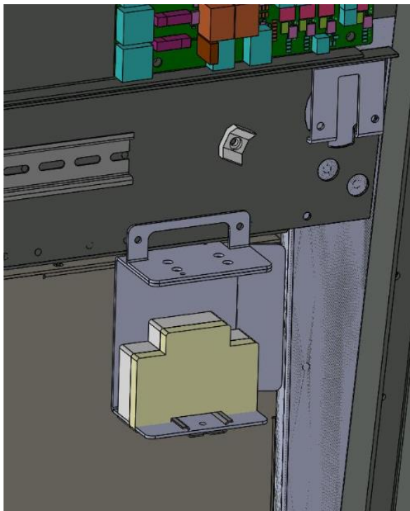
Abbildung 35: Position des externen Not-Aus-Relais im Hypercharger
