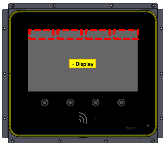
Abbildung 16: Position der abgesetzten eichrechtsrelevanten Anzeige (FPGA-Platine) in der Ladesäule
