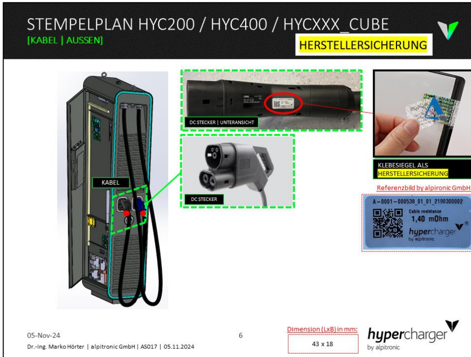
Abbildung 22: Stempelplan Kabel (außen)
