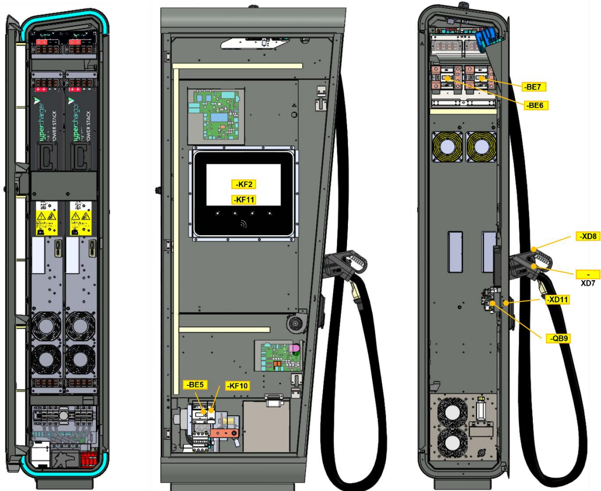
Abbildung 6: Innenansicht hypercharger HYC200 (Service-, Display-, Ladekabelseite)
