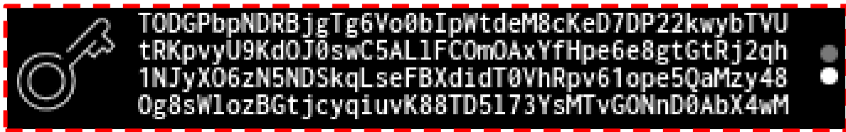
Abbildung 17: Der Public Key des jeweiligen Elektrizitätszählers ist in Klarschrift auf der abgesetzten eichrechtsrelevanten Anzeige dargestellt (hier: beispielhafte Darstellung).
