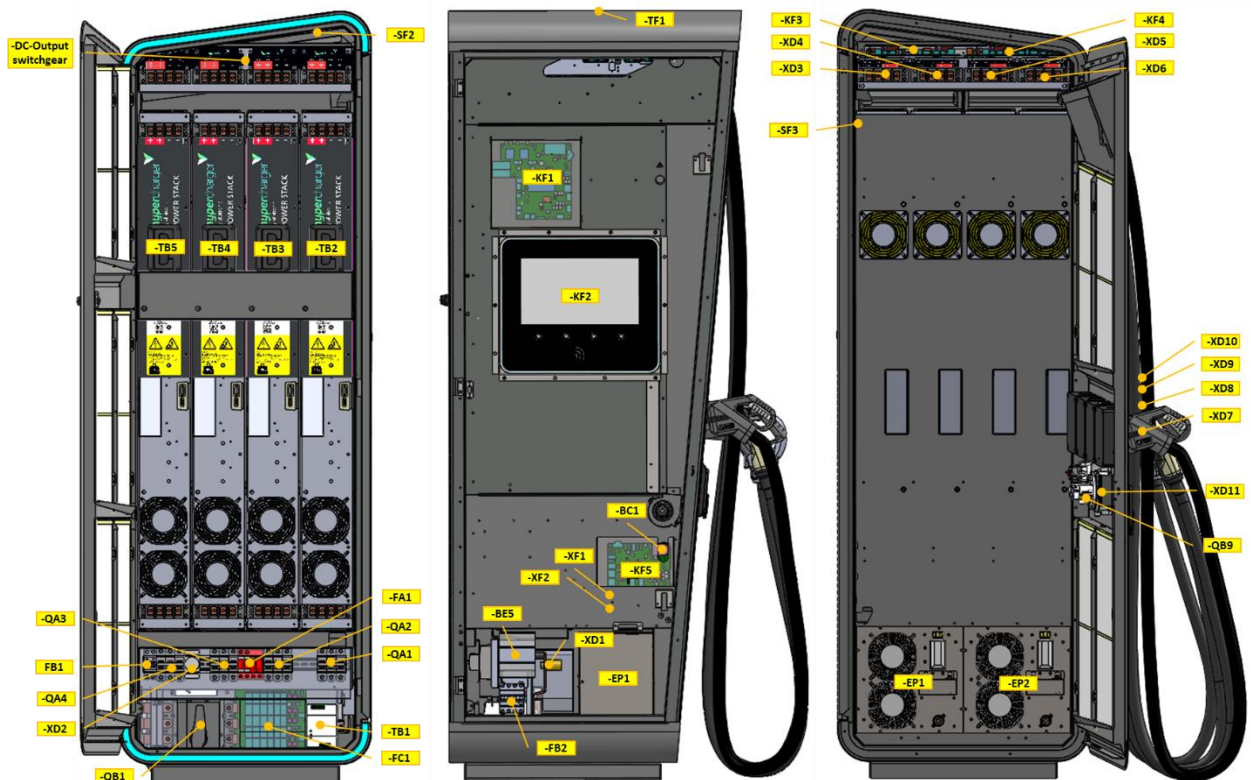
Abbildung 15: Innenansicht hypercharger HYC300 (Service-, Display-, Ladekabelseite)
