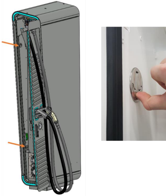
Abbildung 13: Verriegelungsmechanismus für die Displaytür
