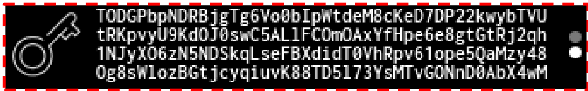
Abbildung 18: Der Public Key des jeweiligen Elektrizitätszählers ist in Klarschrift auf der abgesetzten eichrechtsrelevanten Anzeige dargestellt (hier: beispielhafte Darstellung).
