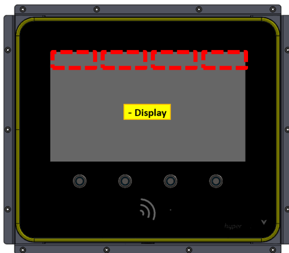
Abbildung 17: Position der abgesetzten eichrechtsrelevanten Anzeige (FPGA-Platine) in der Ladesäule
